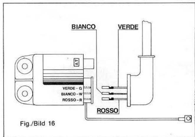
Es ist deshalb notwendig und wichtig, bei Kontrollarbeiten oder Kabellösung, beim Einbau jedes Kabel an der entsprechenden Klemme korrekt zu befestigen, und die entsprechenden Farben zu beachten. (Siehe Abbildung 16).
