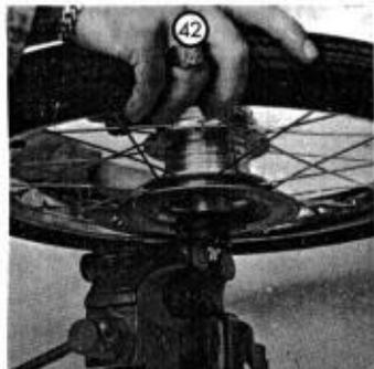
b) - Une fois la roue arrière sortie, il est nécessaire de démonter la roue libre, et pour effectuer ce démontage dans les meilleures conditions, il est vivement recommandé d'utiliser un démonte-roue libre approprié. (photo 42)
