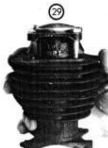
Le cylindre ne comportant pas de chanfrein d'entrée, l'introduction du piston dans le cylindre sera grandement facilitée en utilisant la partie inférieure d'un cylindre de VELOSOLEX 3800 que l'on aura coupé à, environ, un centimètre de la semelle.
