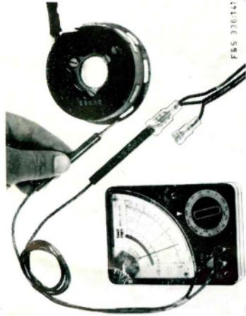
Eine Meßleitung des Ohmmeters an Masse und die andere an das blaue Elektronikkabel anklemmen.
