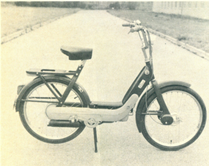
Bild 1 (links) und 2: Gesamtansicht des „Ciao“ als Automatik-Moped Kurzschwingenfederung des Vorderrades, in dem die Zentral-Bremstrommel zu erkennen ist. — Rechts Bild 2: Die Ausführung als 25-km/h-Mofa mit starrer Vorderradgabel und Automatik.
