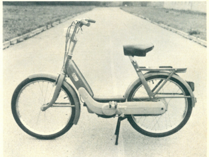
Bild 1 (links) und 2: Gesamtansicht des „Ciao“ als Automatik-Moped Kurzschwingenfederung des Vorderrades, in dem die Zentral-Bremstrommel zu erkennen ist. — Rechts Bild 2: Die Ausführung als 25-km/h-Mofa mit starrer Vorderradgabel und Automatik.
