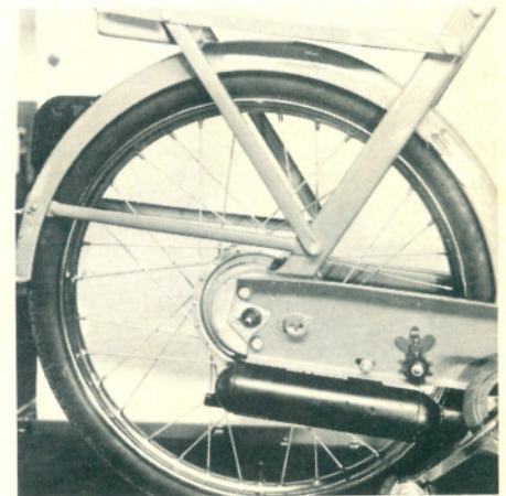
Bild 18: Befestigung des Hinterrads (Lagertrommel) rechts; der Freilauf ist von der Hinterachse abgenommen.
