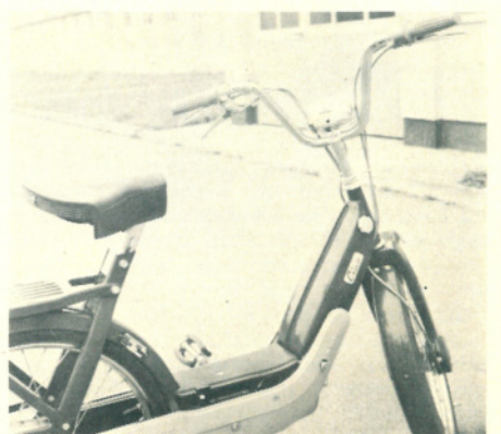
Bild 4: Lenker und Sattel (höhenverstellbar) geben eine gute Fahrposition für die verschiedensten Fahrergrößen, bei motorisierter Fortbewegung wie bei Benutzung als Fahrrad.
