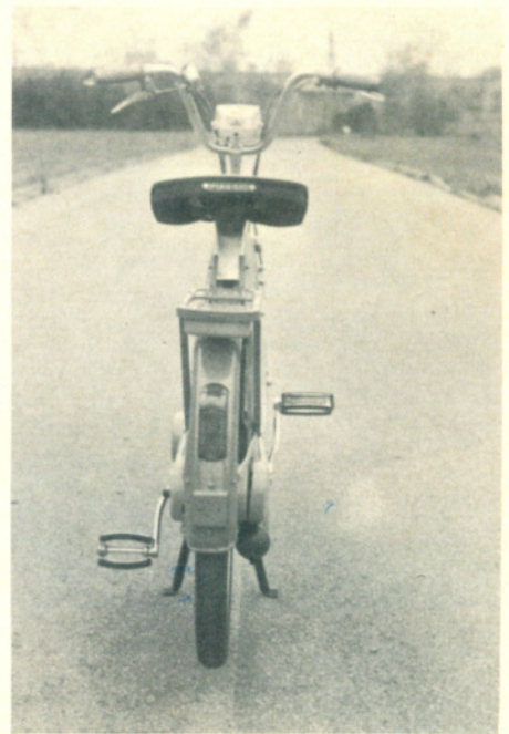
Bild 3: So schmal baut man das Mofa von Vespa, und dementsprechend richtig im Abstand von der Fahrzeugmitte liegen die Pedale.
